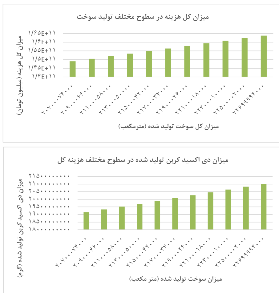
شکل ۳. نمودار جواب‌های پارتو برای توابع هدف سه گانه به صورت دو به دو
