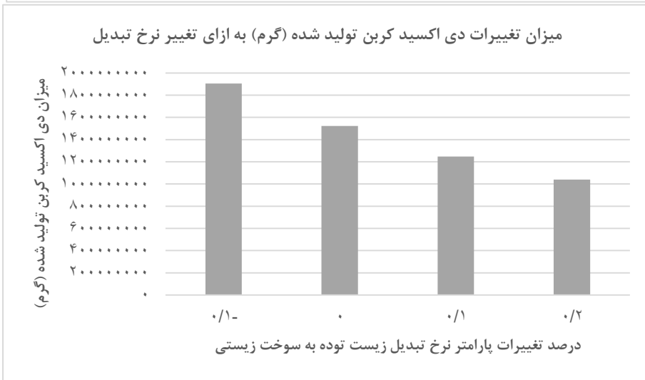
شکل ۷. نمودار میزان تغییرات دی‌اکسیدکربن تولید شده و کل هزینه‌ها به‌ازای درصد تغییر نرخ تبدیل
